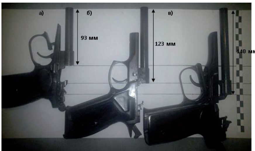
Рис. 1. Порівняння довжини стволів 9 мм пістолетів: а — 9 мм пістолет Макарова ПМ; б — 9 мм пістолет «ФОРТ»; в — 9 мм автоматичний пістолет Стечкина АПС
