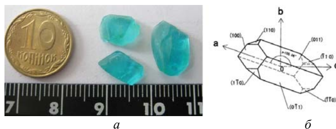
Рис. 1. Зовнішній вигляд вирощених змішаних кристалів K_2Cu_{0,4}Fe_{0,6}(SO_4)_2 \cdot 6H_2O (а) та розміщення кристалографічних осей (б)
