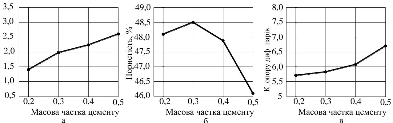
Рис. 1. Графіки зміни основних показників цем'янкового розчину при збільшенні цементу в його складі : а – міцність, б – пористість, в – коефіцієнт опору дифузії водяної пари.
