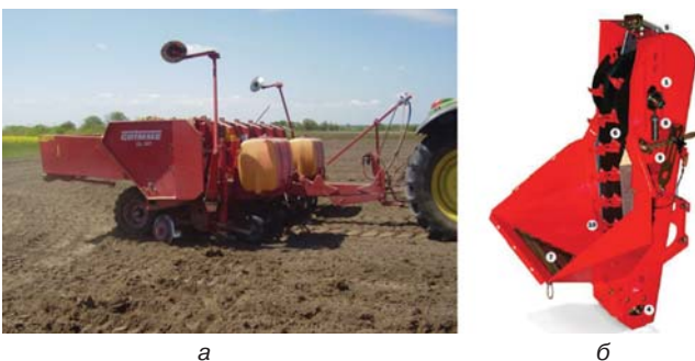
Рис. 3 – Картоплесаджалка з пасово-ложковим саджальним апаратом: а – картоплесаджалка GL-36Т; б – пасово-ложковий саджальний апарат
