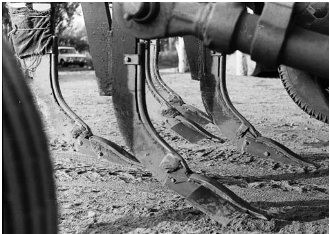
Рис. 4 – Вигляд експериментальних робочих органів чизельного плуга, оснащених S-подібним долотом
