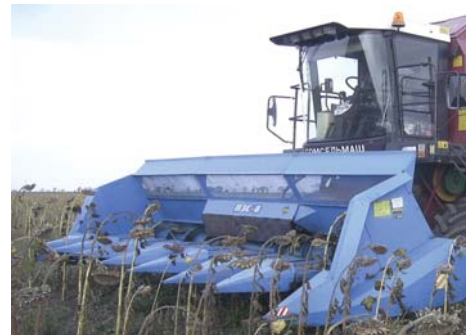
Рис. 11 – Пристрій для збирання соняшнику ПЗС-8-15 в агрегаті з зернозбиральним комбайном КЗС-1218 «Палессе»
