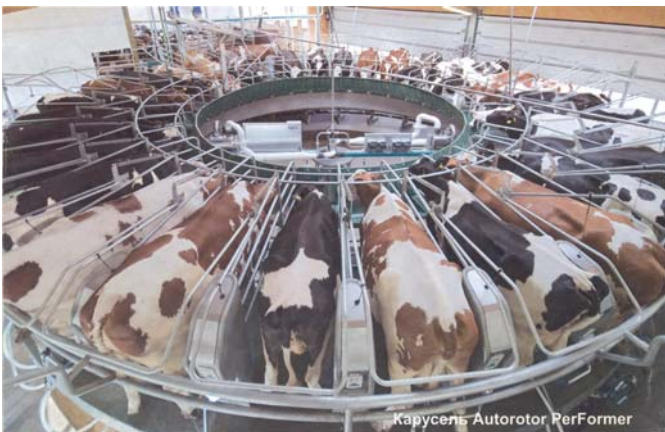
Рис. 3 – Загальний вигляд доїльної установки типу «Карусель»
