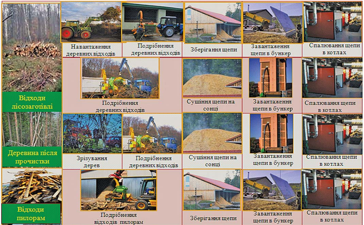
Рис. 2 – Технологічні схеми заготівлі щепи з деревних відходів
