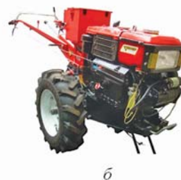
Рис. 8 – Загальний вигляд: а – мотознаряддя з одним опорним колесом; б – мотоблока з двома опорно-привідними колесами, в – мотоблока на гусеничному рушії
