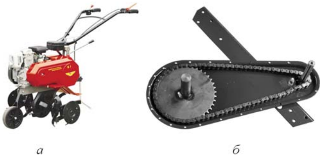
Рис. 5 – Загальний вигляд: а – мотокультиватора Mescanica Benassi RL-7 з ланцюговим редуктором, б – загальний вигляд ланцюгової передачі
