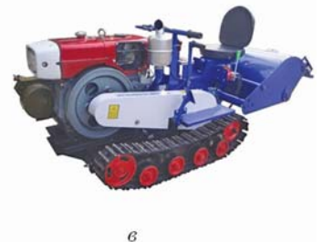
Рис. 8 – Загальний вигляд: а – мотознаряддя з одним опорним колесом; б – мотоблока з двома опорно-привідними колесами, в – мотоблока на гусеничному рушії
