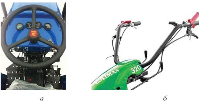
Рис. 11 – Системи керування: а – на міні-тракторах – рульове, б – на мотоблоках і мотознаряддях – штангове
