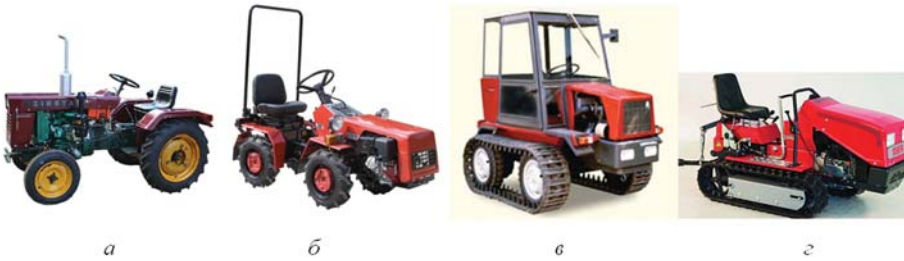
Рис. 9 – Ходові системи малогабаритних тракторів: а – малі передні і більші задні 4К2, б – однакового розміру 4К4, в – колісно-гусеничні, г – гусеничні
