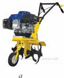
Рис. 8 – Загальний вигляд: а – мотознаряддя з одним опорним колесом; б – мотоблока з двома опорно-привідними колесами, в – мотоблока на гусеничному рушії
