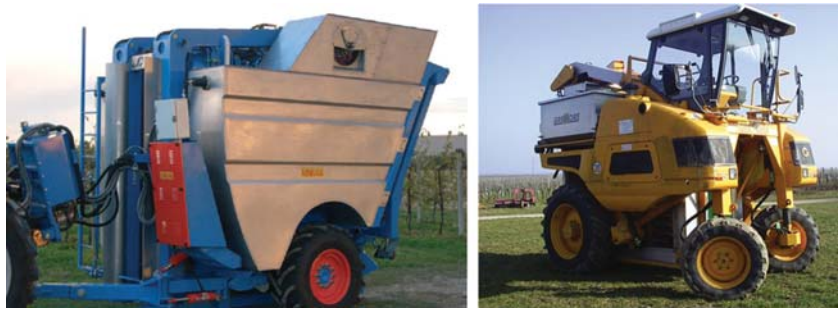
Рис. 14 – Напівпричіпний комбайн для збирання винограду фірми «I.ME.CA» (Італія) і самохідний комбайн фірми «Gregoire» (Франція)
