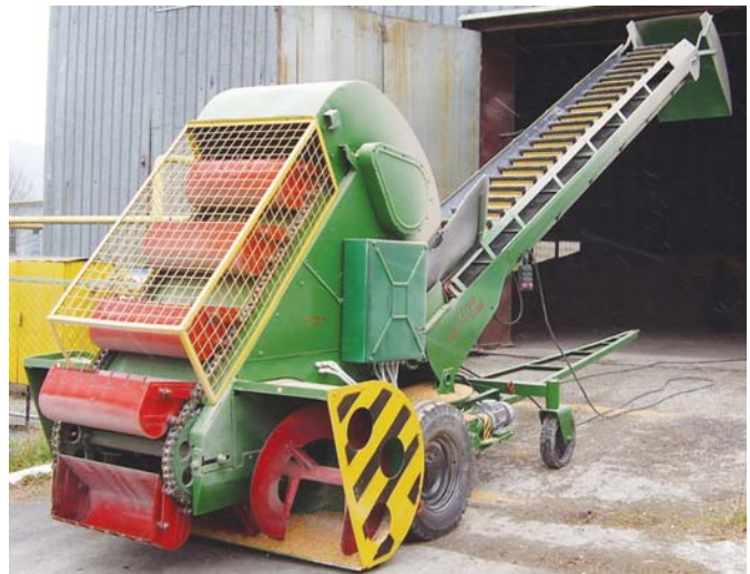
Рис. 1 – Загальний вигляд навантажувача ковшового шнекового марки Р6-КШП-15
