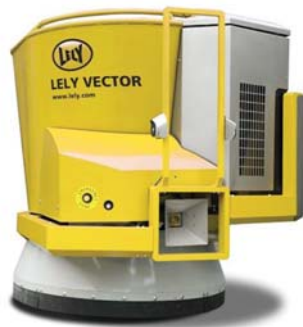
Рис. 4 – Робот для роздавання кормів LELY Vector компанії «LELY»
