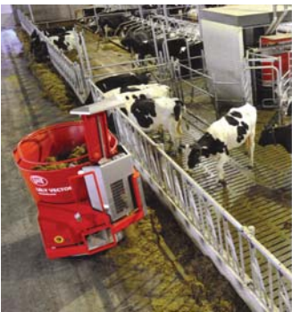
Рис. 4 – Робот для роздавання кормів LELY Vector компанії «LELY»
