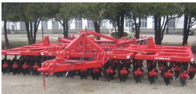
Рис. 2 – Борона дискова модульна БДМП-6х4
