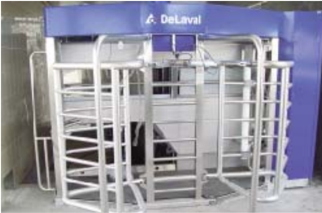
Рис. 1. Загальний вигляд системи добровільного доїння (робот-дояр) «VMS» фірми «DeLaval»
