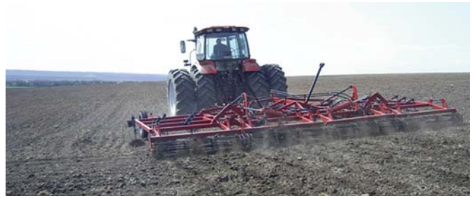
Рис. 5 – Культиватор КСО-8 в роботі
