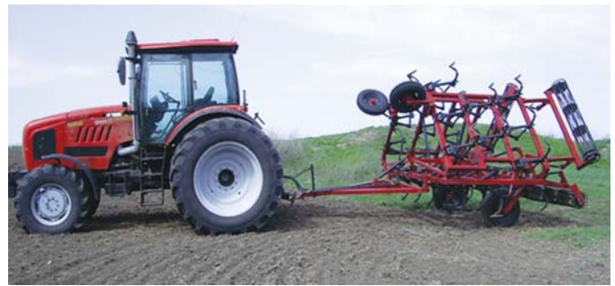
Рис. 2 – Культиватор КСО-8 в транспортному положенні з трактором “Беларус 2022.3”
