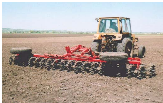
Рис. 4 – Коток ЗККШ-6Г в роботі
