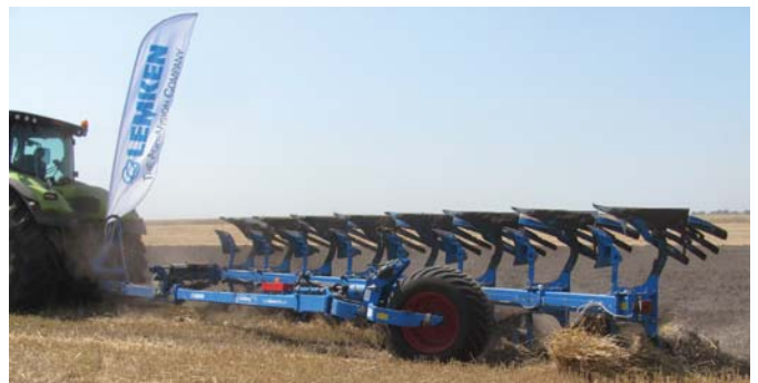
Рис. 6 – 8-корпусний плуг Diamant II фірми LEMKEN в агрегаті з трактором CLAAS AXION 850
