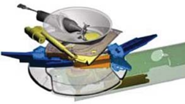
Рис. 17 – Система автоматизованого контролю розкидання добрив по краю поля "Amazone TS" фірми AMAZONE (Німеччина)
