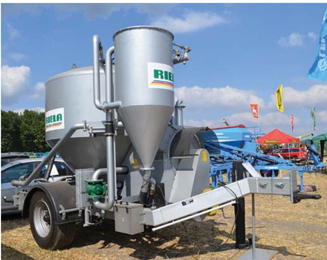
Рис. 18 – Мобільна установка RGM 3500 для приготування кормів фірми RIELA
