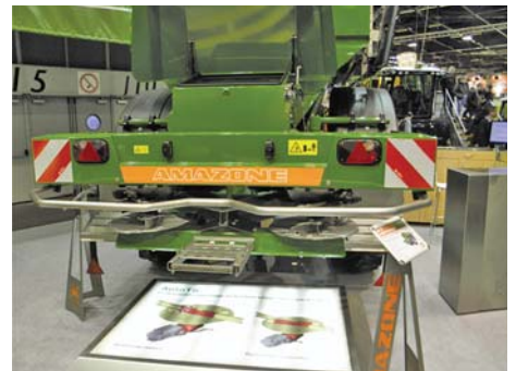
Рис. 16 – Система вибору форсунок з низьким дрейфом на краю ділянки, розроблена фірмою AMAZONE (Німеччина)
