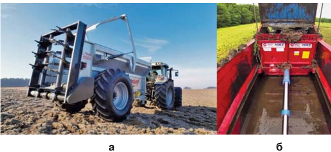
Рис. 1 – Розкидач органічних добрив ADS 120 (а) та механізм подачі добрив типу “рухома стінка” (б)
