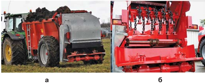
Рис. 4 – Розкидач органічних добрив Xcel 1200 (а) та ланцюгово-молотковий подрібнювальний пристрій (б)
