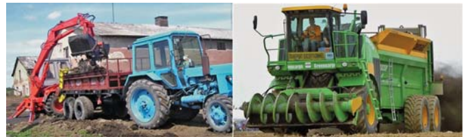
Рис. 8 – Способи завантаження органічних добрив у кузов розкидача: а – навантаження гною навантажувачем ПЕА-1А; б – розкидач органічних добрив Greencargo із завантажувальним пристроєм
