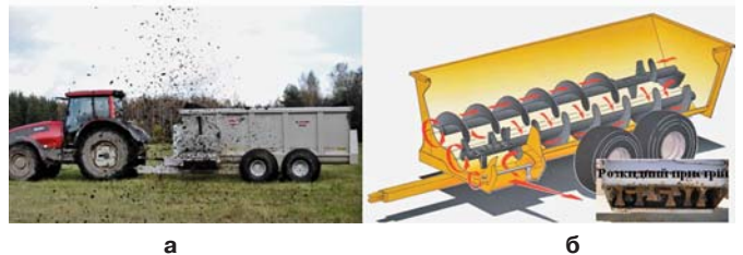
Рис. 2 – Розкидач органічних добрив моделі 8132 (а) та система подачі добрив ProTwin Slinger (б)
