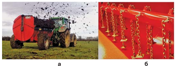
Рис. 3 – Розкидач органічних добрив моделі 1000 (а) та ланцюгово-молотковий розкидний пристрій (б)
