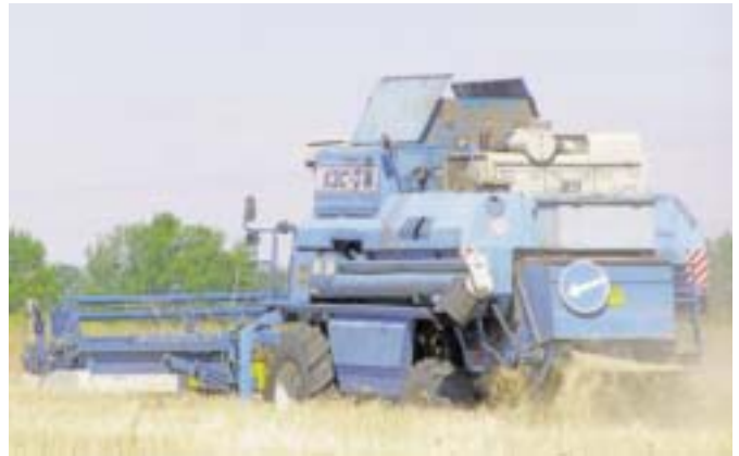
Рис. 1 – Подрібнення та розкидання незернової частини ріпаку комбайном КЗС-9М «Славутич»
