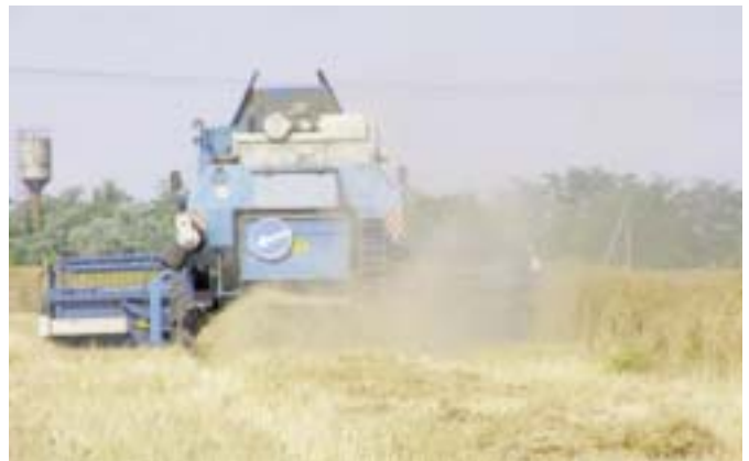
Рис. 2 – Технологічний процес розкидання незернової частини врожаю ріпаку зернозбиральним комбайном КЗС-9М «Славутич»
