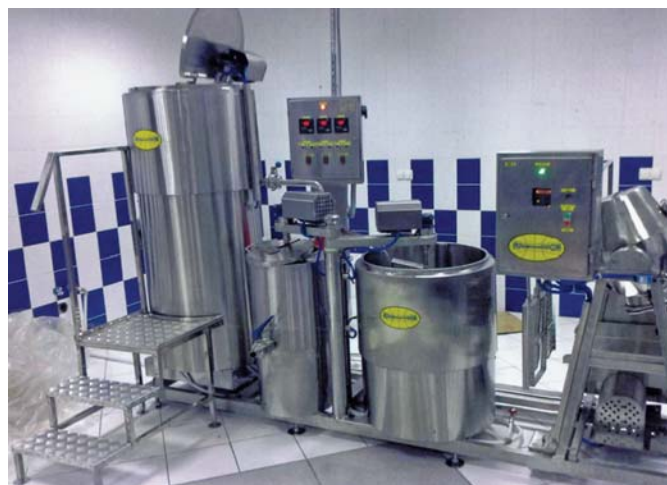
Рис. 44 – Складові лінії переробки молока марки СВВ-10
