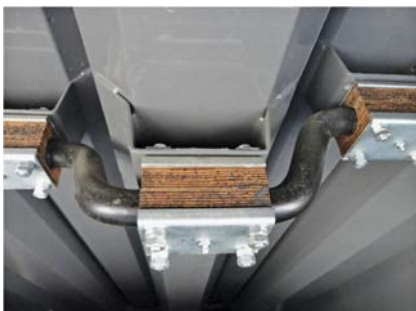
Рис. 35 – Дерев'яні підшипники вала соломотряса
