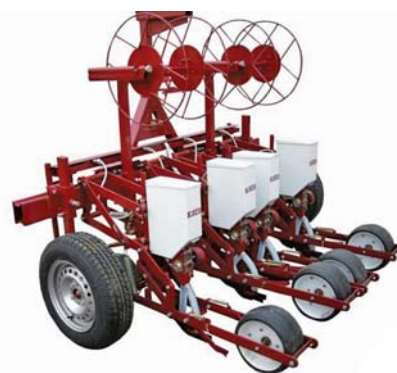
Рис. 28 – Сівалка Клен-1,8 рядкового висіву з обладнанням для укладання капельних трубок
