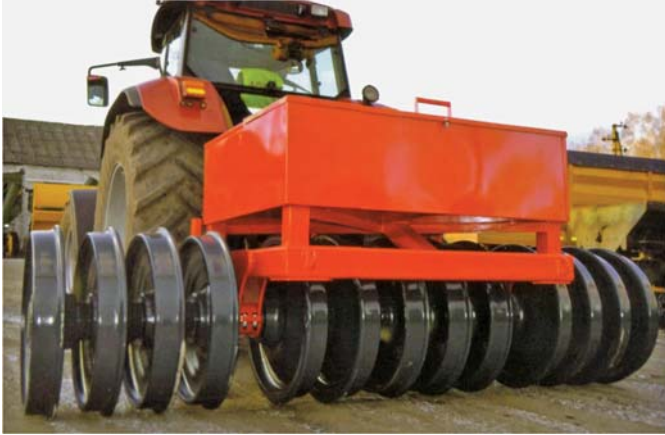
Рис. 38 – Котки для заготівлі силосу і сінажу
