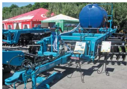
Рис. 21 – Загальний вигляд диско-чизельного агрегата БДВП-4,2-01 з внесенням рідких добрив ТОВ «Краснянське СП «Агромаш»
