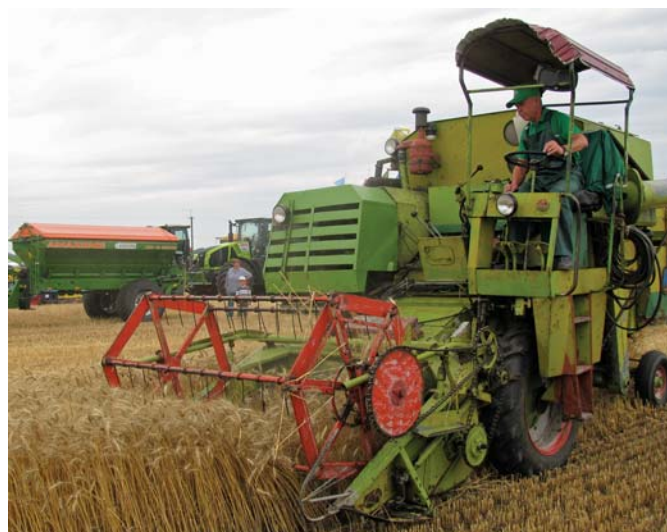
Рис. 5 – Comet 25 – один з перших самохідних зернозбиральних комбайнів виробництва фірми CLAAS (Німеччина) в роботі (рік випуску 1967)
