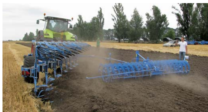
Рис. 7 – Плуг Діамант 11v Variorask фірми LEMKEN в роботі з трактором AXION 930
