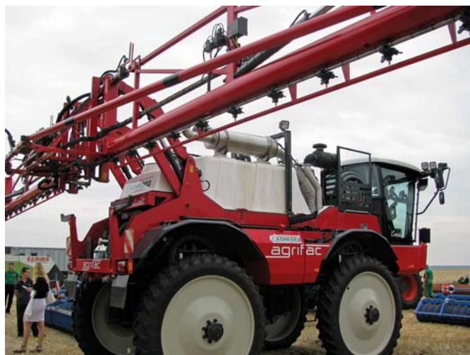
Рис. 10 – Самохідний обприскувач Condor 4000 фірми Agrifac (Нідерланди)
