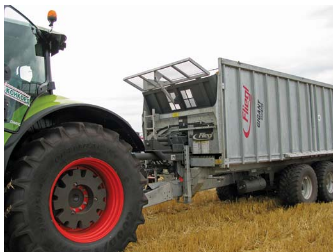
Рис. 6 – Причіп-перевантажувач Gigant ASW 381 фірми Fliegl (Німеччина)
