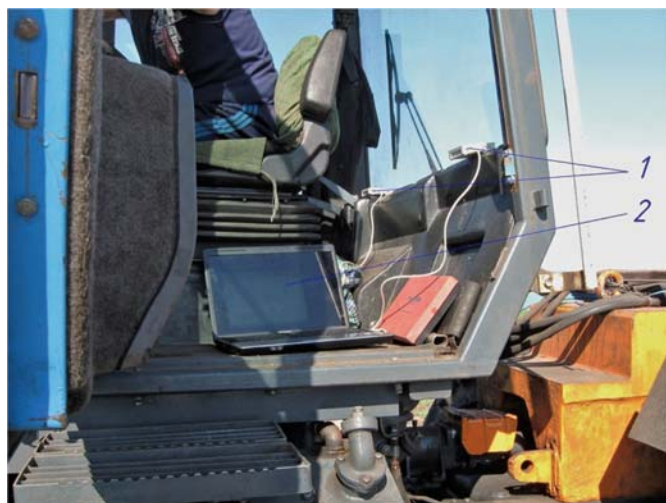
Рис. 3 – Розміщення вимірювально-реєстраційного комплексу в кабіні трактора ХТЗ-17221: 1 – датчики прискорень; 2 – ЕОМ для зняття та архівації даних
