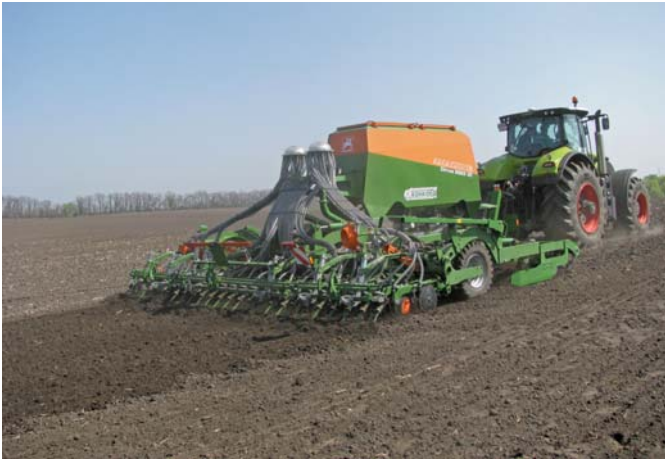
Рис. 12 – Сівалка Cirrus в роботі
