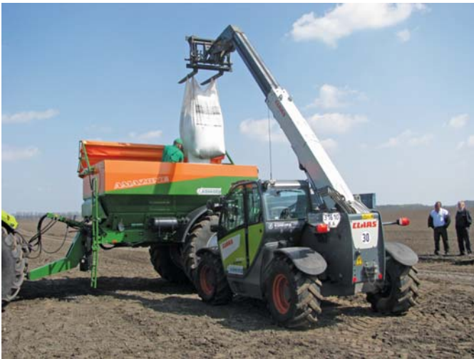
Рис. 7 – Процес завантаження добрив у розкидач мінеральних добрив ZG-TS 8200 завантажувачем CLAAS Scorpion 6030CP
