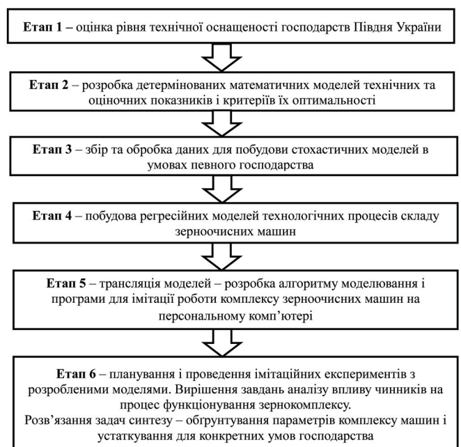
Рис. 1 – Структурна схема етапів обґрунтування параметрів та складу технічних засобів післязбиральної обробки зерна
