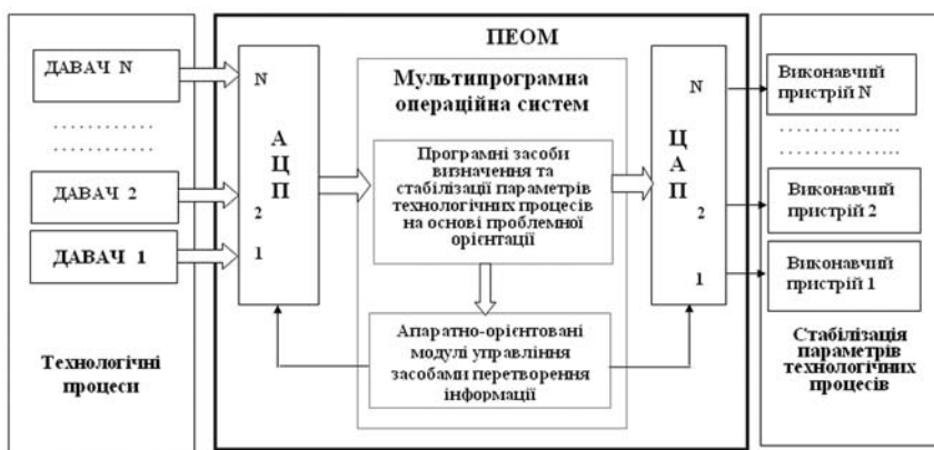
Рис. 1. Структурна схема мультизадачності процесів визначення та стабілізації параметрів технологічних процесів
