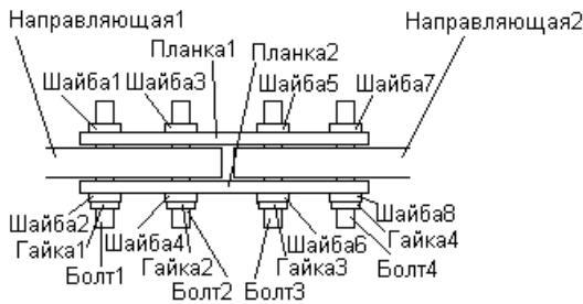
Рис.1. Схема соединения направляющих
