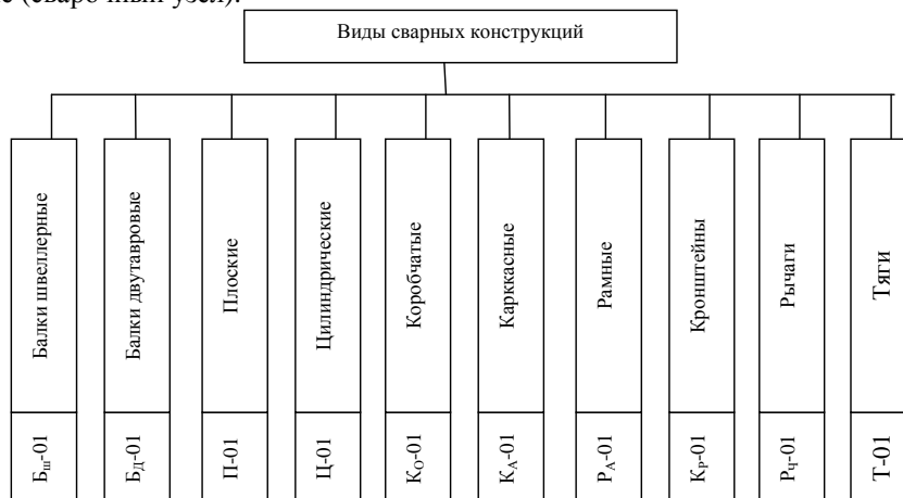
Рис. 1. Фрагмент графа декомпозиции сварных конструкций
