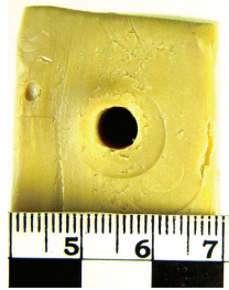
Рис. 2. Одиначна «штанц-марка» навколо вхідного пошкодження в пластилиновому блоці. Постріл упритул із пістолета МР-654К
