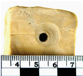
Рис. 3. Подвійні «штанц-марки» навколо вхідних пошкоджень у пластилинових блоках. Постріли впритул з гвинтівок ІЖ-38 ( a ) і МР-512 ( б )
