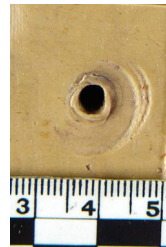
Рис. 3. Подвійні «штанц-марки» навколо вхідних пошкоджень у пластилинових блоках. Постріли впритул з гвинтівок ІЖ-38 ( a ) і МР-512 ( б )
