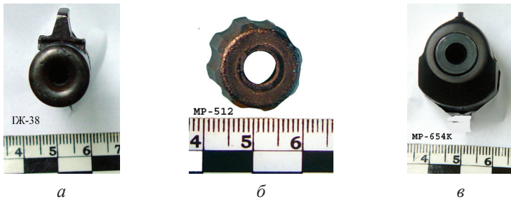
Рис 1. Конструктивні особливості дулового кінця пружинно-поршневих гвинтівок ІЖ-38, МР-512 і газобалонного пістолета МР-654К
