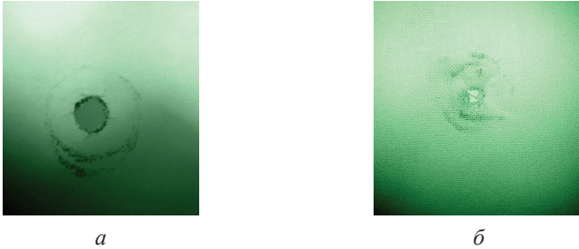
Рис. 5. Подвійні «штанц-марки» навколо вхідних отворів у мішенях з бавовняної тканини. Постріли впритул із гвинтівок ГЖ-38 (а) і МР-512 (б). Зйомка у відбитих інфрачервоних променях
