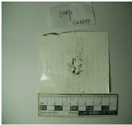
Рисунок. а б Топографія відкладення міді з відстані в межах 5 см при стрільбі: а – з пістолета ПСМ штатними (бойовими) патронами калібру 5,45 мм; б – з пістолета ПСМ-Р штатними патронами калібру 9 мм, спорядженими кулями нелетальної дії (гумовими)
