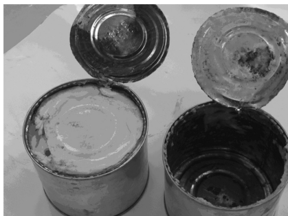
Рис. 2. Пятна окиси железа в консервах длительного хранения
