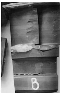
Рис. 2. Общий вид разрушенной лопатки
