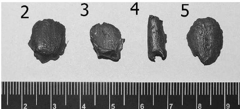
Рис. 11. Фрагменти 5,6 мм куль після рикошету (один бік)
