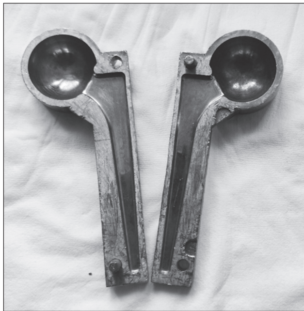
Рисунок 3. Розбірна прес-форма I покоління для інтраопераційного виготовлення спейсера, 50-й розмір
