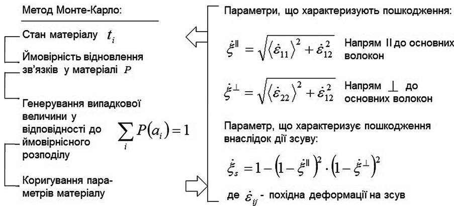
Рис. 1. Реалізація ймовірнісної моделі пошкодження композиційного матеріалу за методом Монте-Карло
