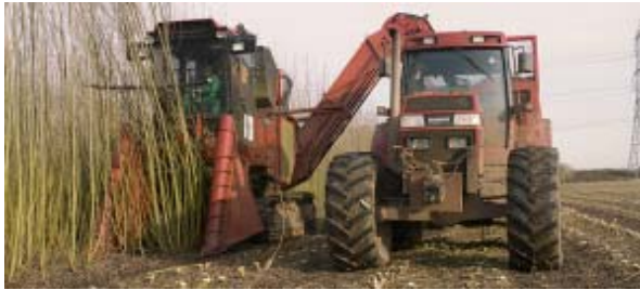
Рисунок 2 – Збирання верби тростинозбиральним комбайном Case IH 7000 series Austoft
