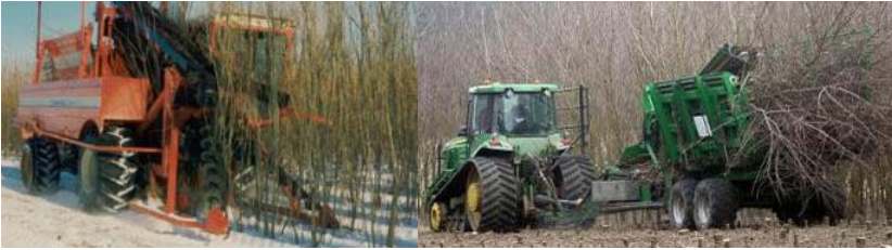
а – самохідна машина Empire 2000; б – причіпна машини NB STEMSTER III
