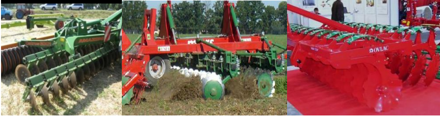
Рисунок 3 - Дискові борони і агрегати з гумовими (а), пружинними (б) та ресорними (в) амортизаторами
