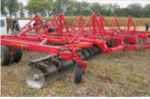
Рисунок 1 - Борона SUNFLOWER 1544-42 (а) з опорними стояками C-Flek™ (б)
