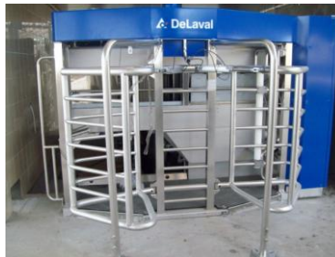
Рисунок 2 – Загальний вигляд системи добровільного доїння (робот-дояр) «VMS» фірми «DeLaval»
