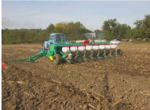
Рисунок 7 – Сівалка «Весна-8» в роботі
