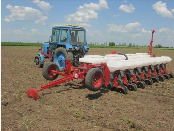
Рисунок 6 – Сівалка «Вега-8» з електроприводом в роботі
