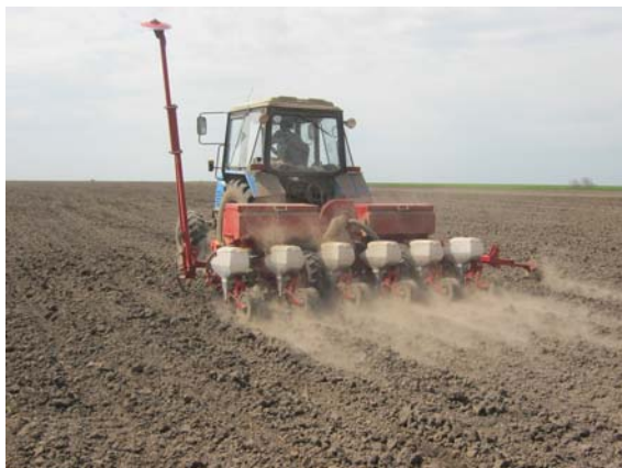
Рисунок 2 – Сівалка універсальна пневматична «Vesta-6 Profi» в роботі
