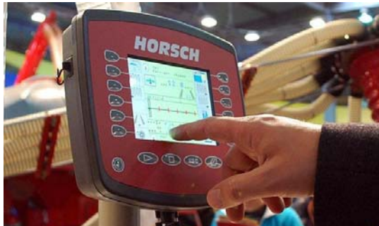
Рисунок 7 – Система контролю IsobusDriiiManager сівалки
