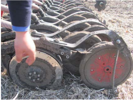
Рисунок 4 – Висівні сошники TurboDisc із прикочувальними роликами та пружинними загортачами
