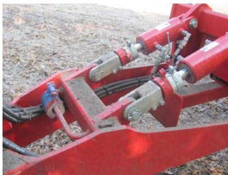
Рисунок 8 – Гідравлічне регулювання висоти присєднання причпного пристрою
