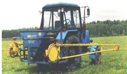
Рисунок 7 – Штанговая машина с цепочно-шайбовым транспортером РШУ -12
