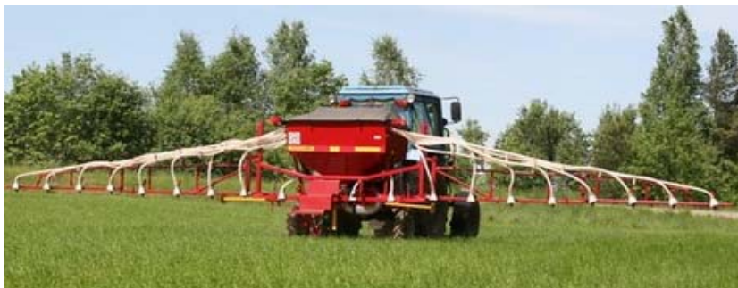
Рисунок 1 – Пневматический штанговый распределитель твердых минеральных удобрений СУ–12 (Беларусь) с пневматическим делением потока
