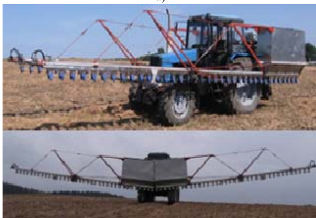
Рисунок 10 – Штанговые машины со шнеко-катушечными распределяющими рабочими органами МШВУ-18 (а) и РШУ-18 (б)
