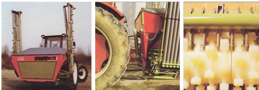
Рисунок 2 – Пневматический разбрасыватель минеральных удобрений DPS 12 фирмы Nodet gougis (Франция) с механическим делением потока
