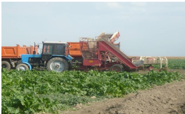
Рисунок 3 – Погрузчик «Gilles» К-136 в работе
