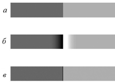
Рис. 2. Підвищення контрасту меж зображення: a – вихідне зображення; б – межа контрастована методом “нерізкої маски” [7]; в – межа, контрастована використанням оператора Лапласа
