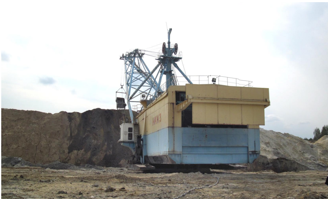
Рис. 4. Крокуючий екскаватор для зняття розкривних порід
