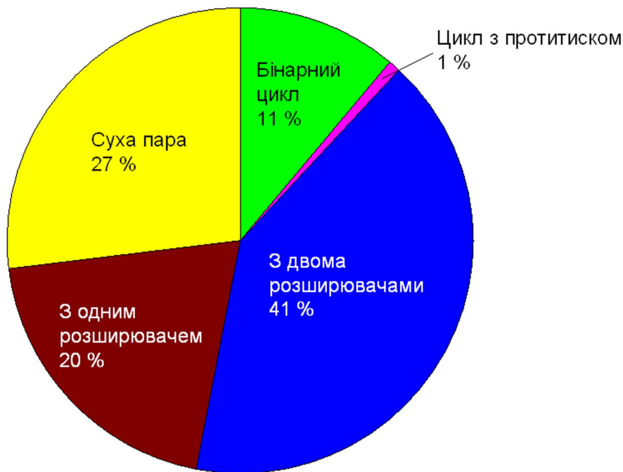
Рис. 2. Дані щодо розподілу за типами технологій енергоблоків ГеоЕС, запущених в експлуатацію після 2005 року (усього 139 блоків)
