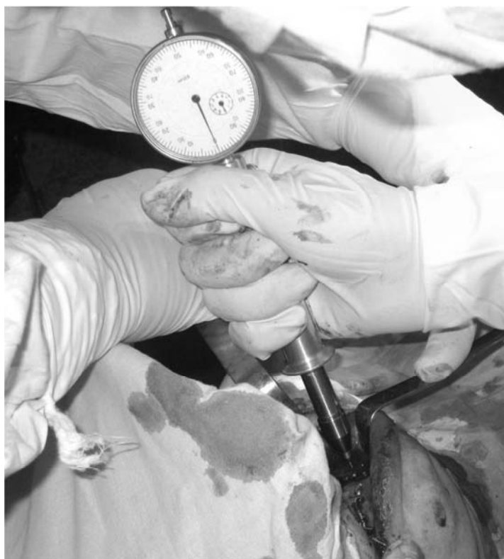
Рис. 2. Інтраопераційне вимірювання твердості кісткової тканини із використанням розробленого приладу.
