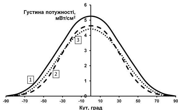
Рис. 5. Індикатриси зворотного розсіяння лазерного випромінювання: 1 – фемтосекундний режим, здорова біотканина, 2 – фемтосекундний режим, патологічна біотканина, 3 – неперервний режим, здорова біотканина
