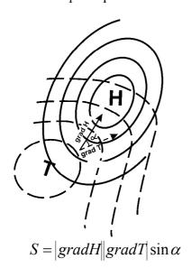
Рис. 8 — Схема расчета величины S, K/м (обозначения общепринятые).
