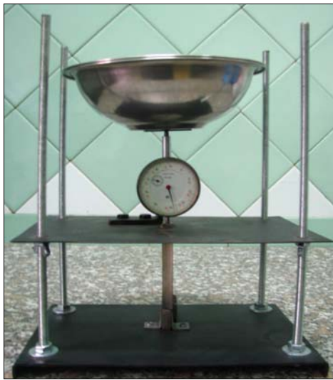
Рис. 1. Внешний вид устройства для определения биомеханических характеристик костей крыс.
