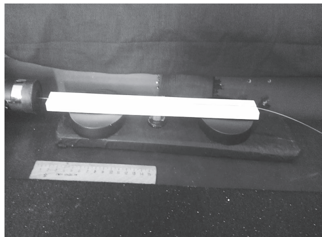
Рис. 3. Установка для измерения светового выхода сцинтилляционных стрипов
